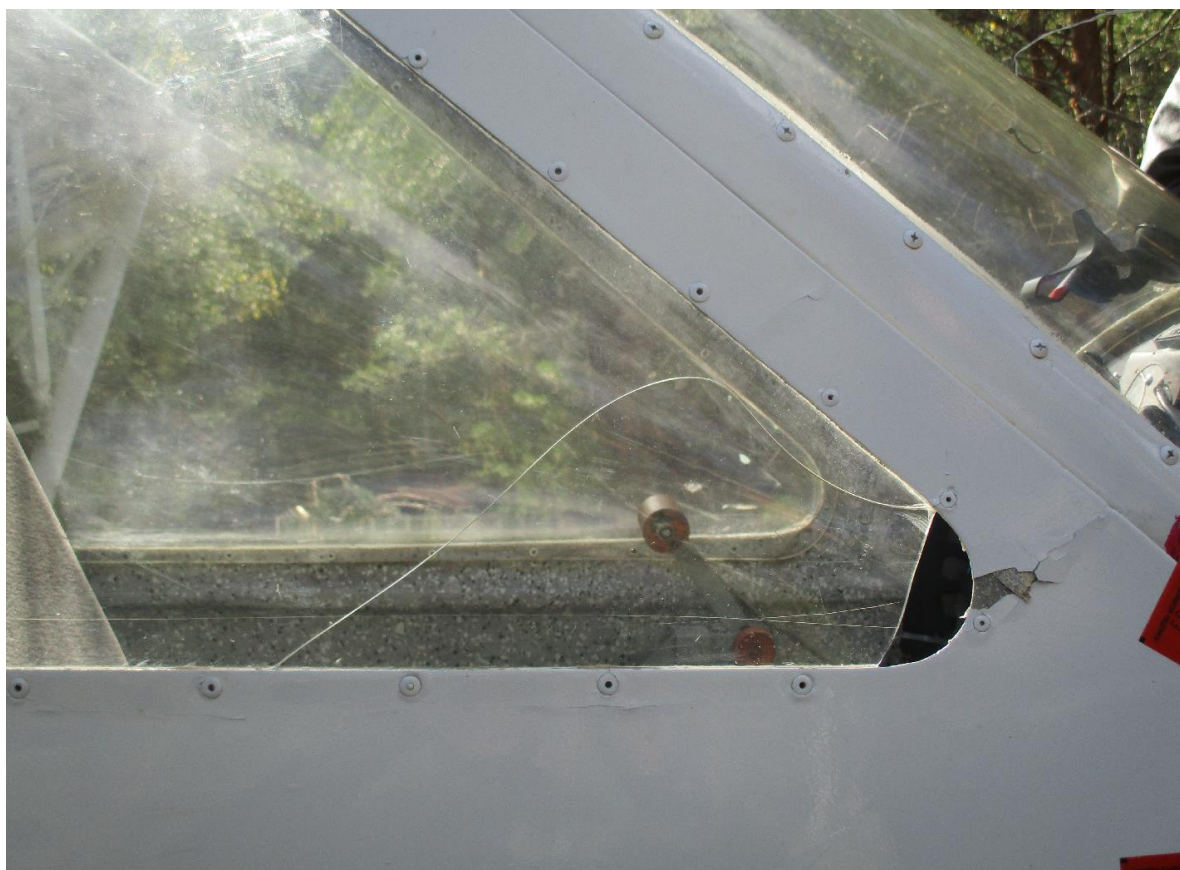
Рис 3. Поврежденное остекление правой двери кабины пилота
