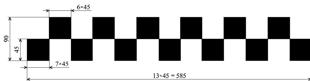
Требования к размерам отличительного знака обслуживания, который наносится на опознавательный фонарь автомобиля-такси, мм
